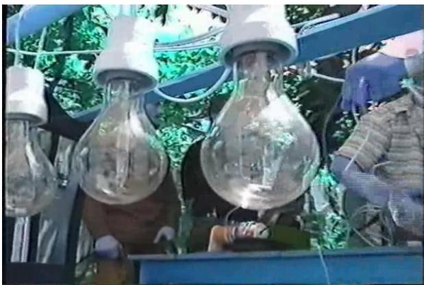
**Figure 8. Kilowatt load lamps**
