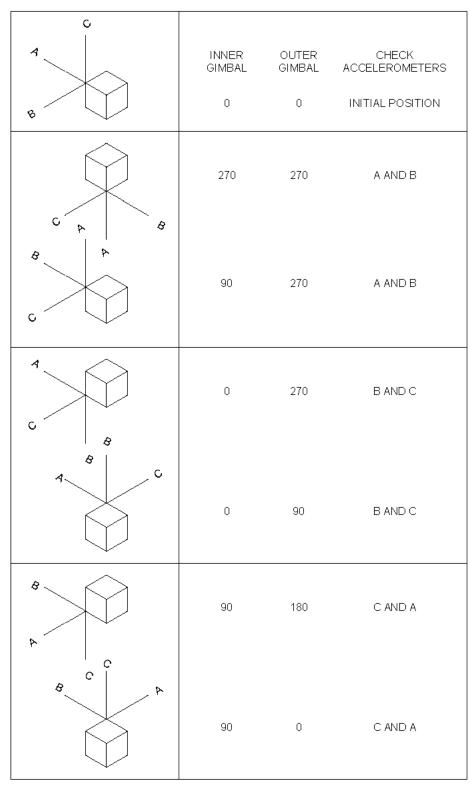
ACCELEROMETER PHYSICAL ORIENTATIONS DURING ACCELEROMETER TESTS
