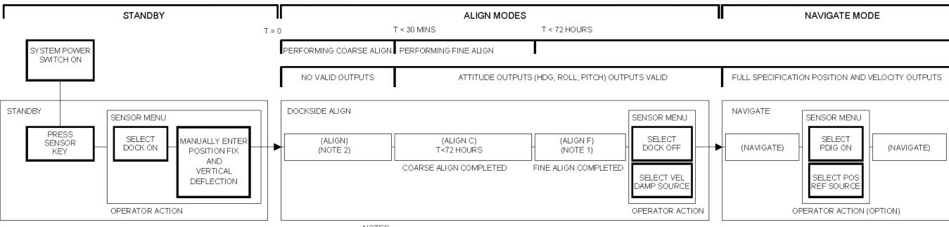
DOCKSIDE ALIGN/CALIBRATION (NON-CALIBRATED SYSTEM)
