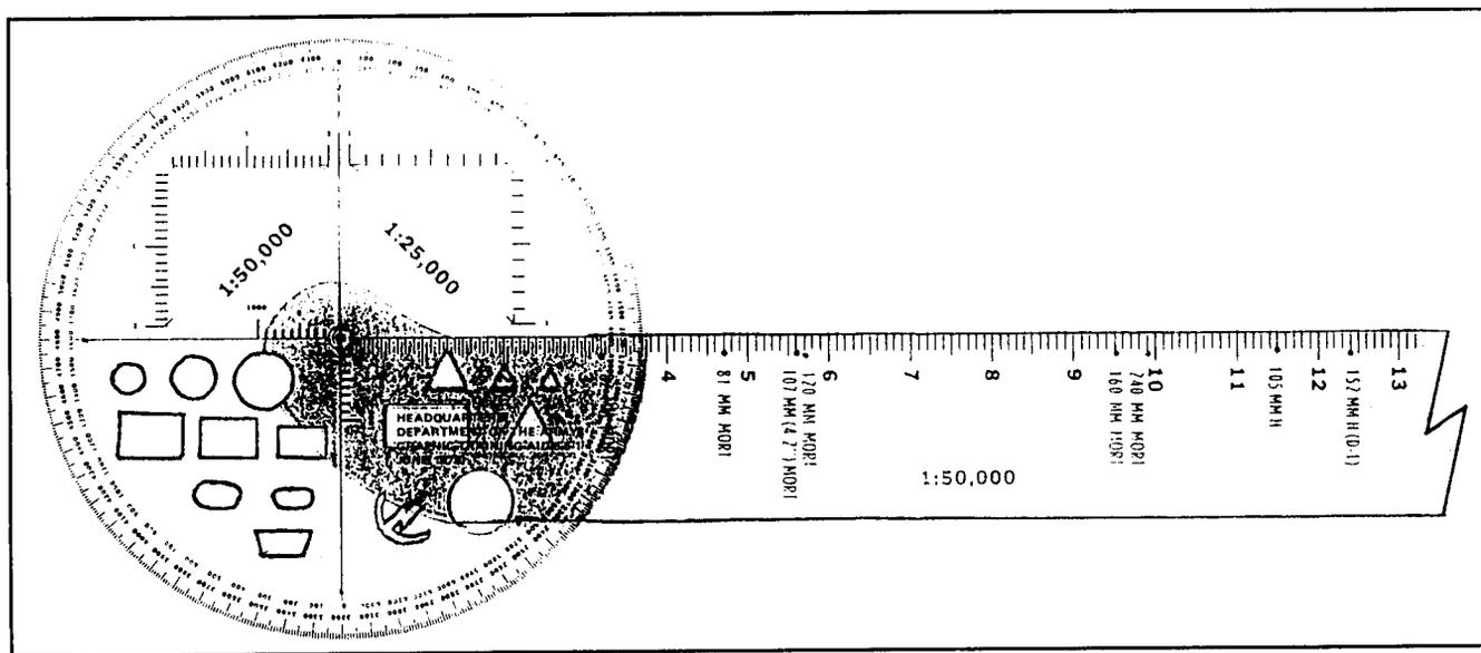
**Figure 14-1. Range-Azimuth Fan.**
